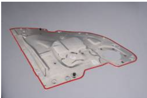
Bild 1: Fertig abgedichtetes Türmodul
